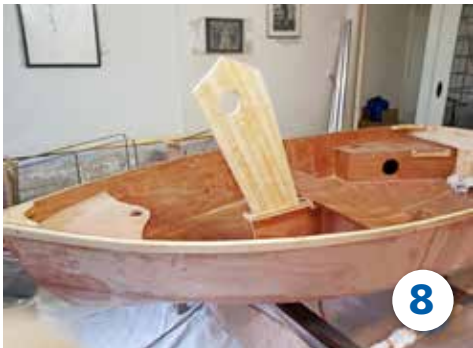
8 Zwaard en roer bouwen; met de rudderkit en riggingkit is dat goed te doen.
