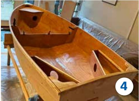
4 De hoekversterkingen lijmen, de banken en water-dichte tanks monteren.
