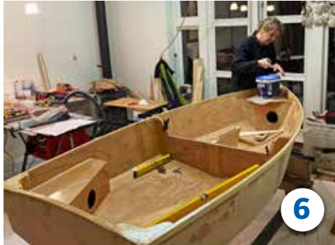
6 Mastvoet maken en stellen, en de binnenzijde van de boot in epoxy en schuren.
