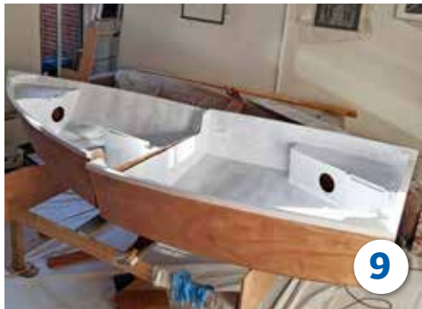
9 De buitenzijde in glasvezel en epoxy zetten en dan afwerken: ontvetten, goed schuren, weer ontvetten en twee tot drie lagen tweecomponenten polyurethaanverf aanbrengen
