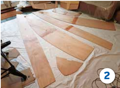
2 Zagen en volgens de 'naai en plak'-methode huid-delen aan elkaar bevestigen met tiewraps. Daarna uitvouwen en de hoofdschotten plaatsen, naden lijmen met fillets en versterken met glasvezel.
