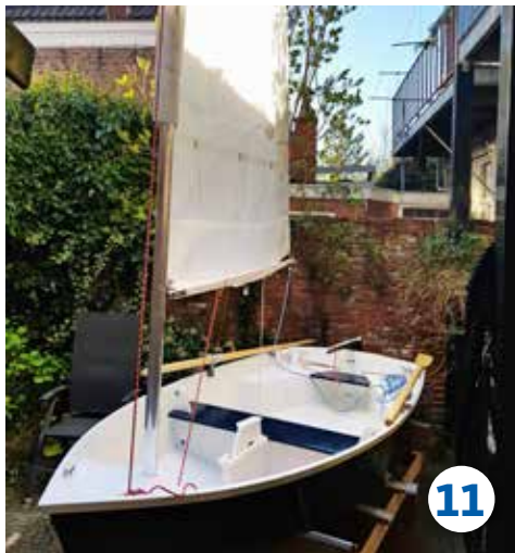
11 Mast en giek assembleren, beslag monteren (boorgatjes in epoxy zetten!) en tuigen.
