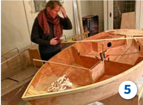
5 Zwaardkast maken: eerst de binnenzijde afwerken en vervolgens inlijmen.
