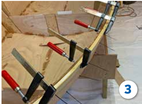
3 Dek of stootrand assembleren en lijmen: veel lijmklemmen is handig! Goed laten uitharden.
